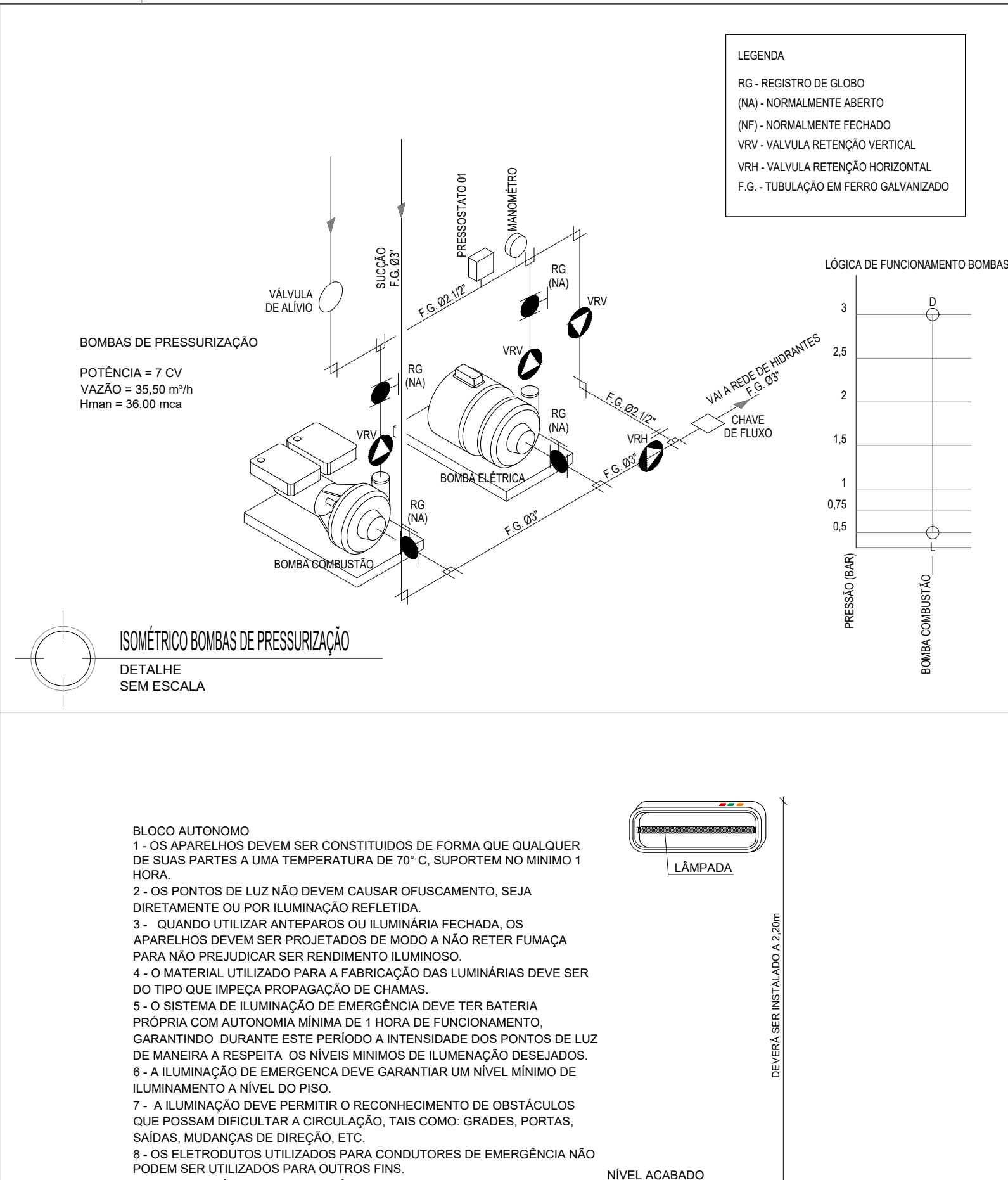
ISOMÉTRICO BOMBAS DE PRESSURIZAÇÃO DETALHE SEM ESCALA
